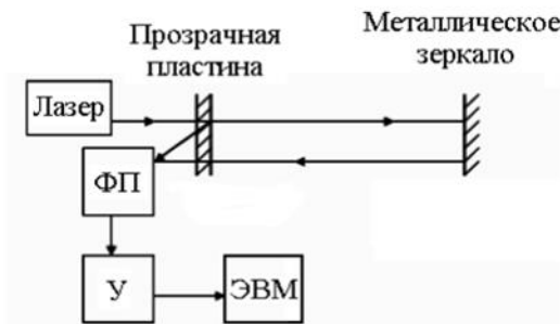
Рис. 7– Структурная схема интерферометра Фабри-Перо (ФП – фотоприемник, У - усилитель)
